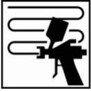
Einen mittleren geschlossenen Spritzgang auftragen, gefolgt von einer Abluftzeit von 3-5 Minuten bei 20°C. Anschließend eine volle Schicht auftragen und vor der Ofentrocknung eine Abluftzeit von 3-5 Minuten bei 20°C gewähren.
