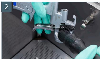
2 Reinigen des Pistolenkörpers
