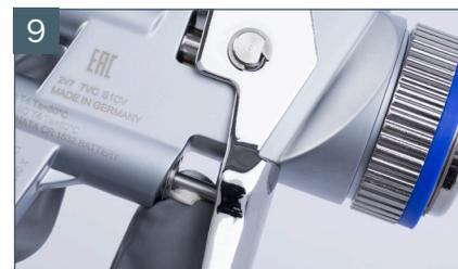
Sichtbarer Bereich der Luftkolbenstange einfetten
