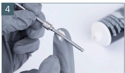
Farbnadel im Bereich der Nadeldichtung einfetten
