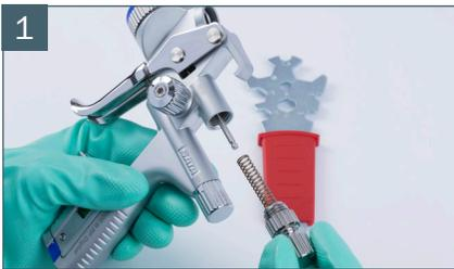
1 Beim Ausbau des Düsensatzes wird zuerst die Farbnadel herausgenommen.
