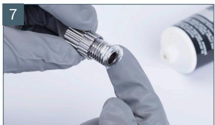
Gewinde der Materialmengenregulierschraube einfetten
