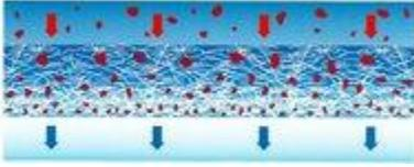
Progressiv verdichtetes, synthetisches, thermisch gebundenes Gewebe mit hoher mechanischer Festigkeit im Faserverbund. Die einzigartige Vlieskonstruktion sichert hohe Abscheidegrade bei hoher Staubspeicherfähigkeit. Der Filter erreicht dadurch hohe Filtereffizienz.
