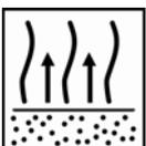
Zwischen den Schichten eine Abluftzeit von 5-10 Minuten bei 20°C gewähren.
