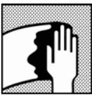
Entfernen Sie vor dem Auftragen von Decklack jegliche Oberflächenverunreinigung unter Verwendung entsprechender Oberflächenreiniger.
